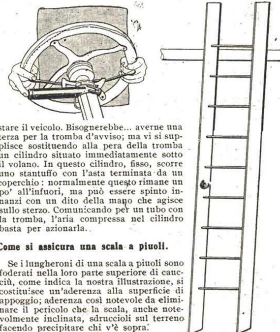
stare il veicolo. Bisognerebbe... averne una terza per la tromba d'avviso; ma vi si supplisce sostituendo alla pera della tromba un cilindro situato immediatamente sotto il volante. In questo cilindro, fisso, scorre uno stantuffo con l'asta terminata da un coperchio: normalmente questo rimane un po' all'infuori, ma può essere spinto innanzi con un dito della mano che agisce sullo sterzo. Comunicando per un tubo con la tromba, l'aria compressa nel cilindro basta per azionarla.
